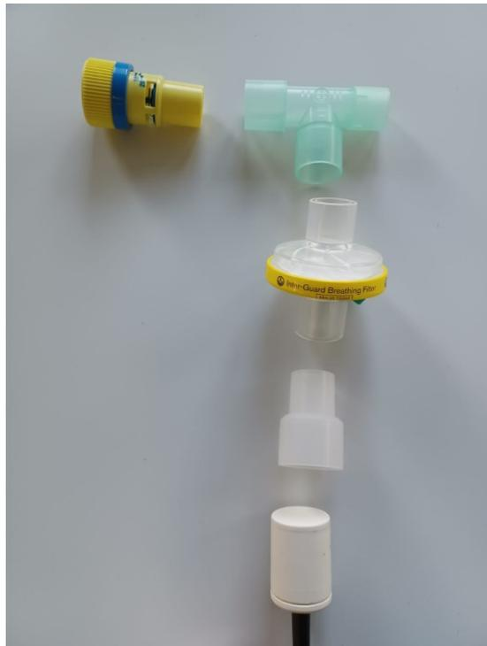
**Figura 20: Assemblaggio valvola di PEEP, adattatore, raccordo a T e sonda multiparametrica**
