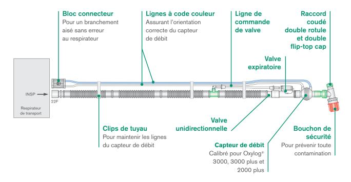
Le circuit illustré est pour une utilisation sur Oxylog® 3000, 3000 plus et 2000 plus.
